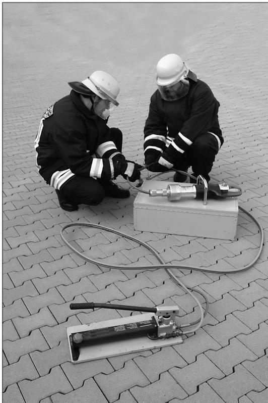
Das Schneidgerät, die handbetriebene Hydraulikpumpe und das Zubehör werden mit dem Transportkasten an der Einsatzstelle bereitgestellt. Die an dem Schneidgerät und an der handgetriebenen Hydraulikpumpe befindlichen Hydraulikschläuche werden durch Schließen der Steckkupplungen verbunden. Das Gerät ist damit betriebsbereit.
