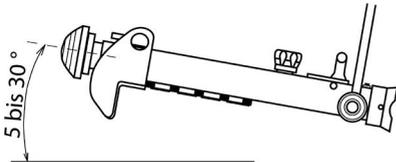
Bei Schräglage über 30° kann die komplette Hubhöhe nicht erreicht werden, da die volle Ölmenge nicht genutzt werden kann.
