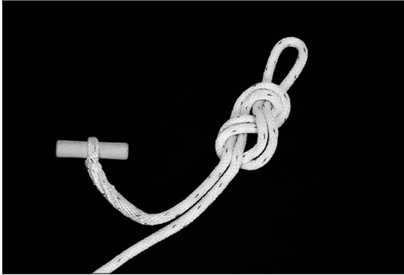
Der Achterknoten ist ein Verbindungs- und Befestigungsknoten. Er dient vorrangig zur Einbindung im Auffanggurt beim Halten und Auffangen sowie als Befestigungspunkt am Ende der Feuerwehreine bzw. des Dynamikseils.
