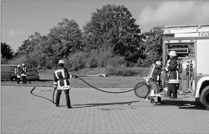
Der Truppmann nimmt das Strahlrohr aus der Halterung und geht mit dem Truppführer vor. Ein weiterer Trupp unterstützt bei Erfordernis beim Abziehen und Auslegen der Druckleitung. Auf das Kommando „Wasser marsch!“ öffnet der Maschinist das Absperrorgan an der Pumpe und gibt Wasser.
