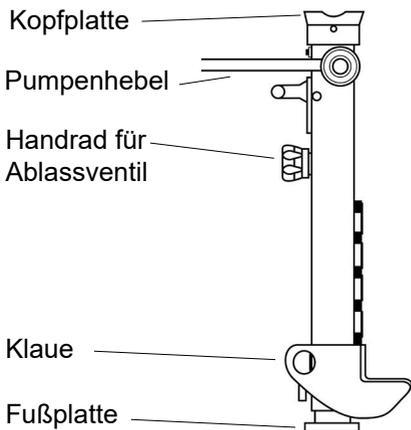
Zubehör der hydraulischen Winde
