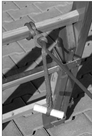
Die Standsicherheit der Leiter und die Verbindung der Leiterteile untereinander sind zu beachten. Die Verbindung erfolgt in der Regel mit Mehrzweckleinen.
