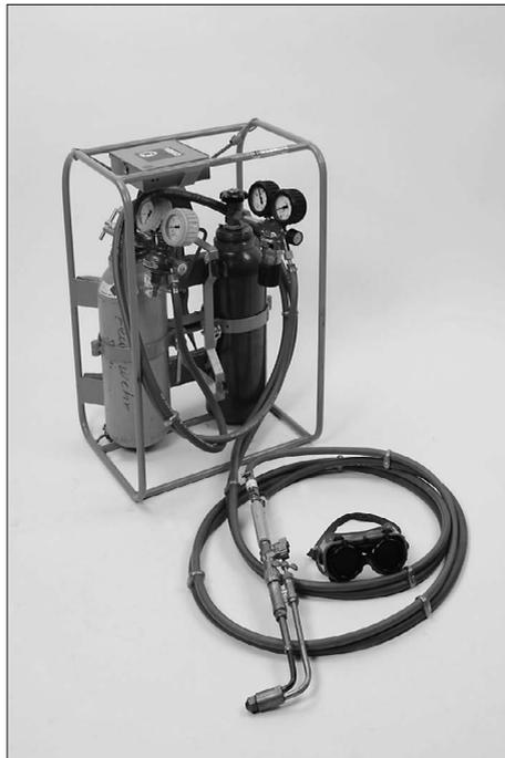
Das Brennschneidgerät besteht aus Tragegestell, Sauerstoff-Flasche und Acetylen-Flasche mit Druckminderer, Schneidbrenner mit Schneiddüse, einem Satz Gasschläuche für Sauerstoff und Acetylen sowie Zubehör. Als Reserve werden zwei Sauerstoff-Flaschen und eine Acetylen-Flasche mitgeführt.
