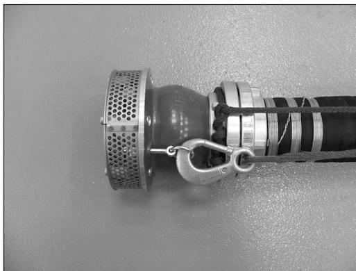
Die Ventilleine wird mit dem Karabinerhaken in das Auge oder den Ring des Rückschlagorgans eingehängt.
