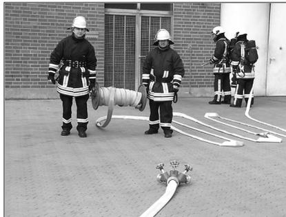
Bei der tragbaren Schlauchhaspel muss die Schlauchleitung von unten abrollen.
