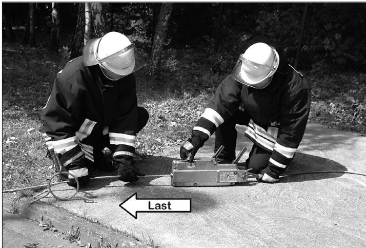
Am Mehrzweckzug befinden sich ein Vorschub- und ein Rückzughebel sowie ein Schaltgriff zum Arretieren und Lösen des Zugseils. Im Vorschubhebel ist eine Überlastsicherung (Scherstifte) eingebaut.
