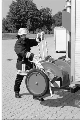
Beim Absetzen der Schlauchhaspel arbeiten Wassertrupp und Maschinist zusammen. Das Absetzen der Ein-Mann-Haspel(n) erfolgt durch den Maschinisten.
