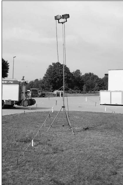
Die Anschlussleitungen der Flutlichtstrahler werden mit den Abgängen des Abzweigstücks verbunden und das Abzweigstück an die elektrische Leitung zum Stromerzeuger beziehungsweise an die Steckdose des Leitungsrollers angeschlossen.
