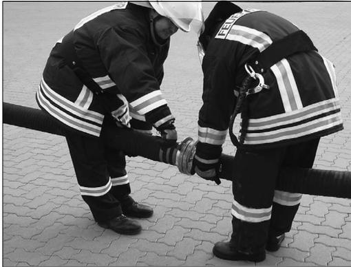
Die Saugschläuche werden beim Kuppeln zwischen den Beinen festgehalten. Die Kupplungen werden von Hand vorgekuppelt. Durch Rechtsdrehen fassen die Knaggen und werden mit dem Kupplungsschlüssel nachgezogen.
