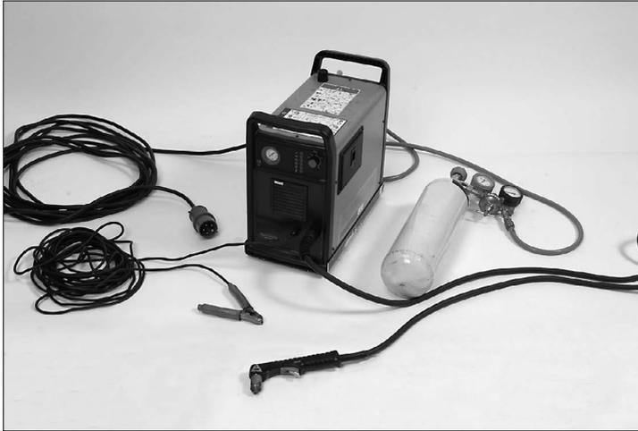
Das Plasmaschneidgerät dient zum Trennen von metallischen leitfähigen Stoffen. Die durch den Brenner strömende Luft wird ionisiert. Der so gebildete Plasmastrahl hat eine sehr hohe Energiedichte und mit 10.000 – 20.000 °C eine sehr hohe Temperatur, wodurch der metallische Werkstoff geschmolzen und aus der Schnittfuge heraus getrieben wird.
