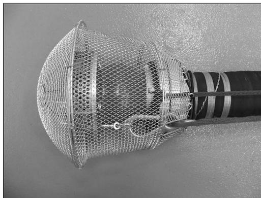
Beim Anbringen eines Saugschutzkorbes darf die Ventilleine nicht eingeklemmt werden.
