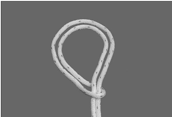
Der doppelte Ankerstich dient u. a. zum Befestigen von Geräten beim Hochziehen.
