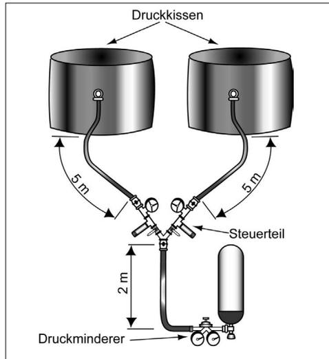
Das Hebekissensystem besteht aus Druckkissen mit Füllschlauch, einer Druckluftflasche mit Druckminderer, einem Luftschlauch zur Verbindung von Druckminderer und Steuerteil und dem Steuerteil mit Kupplungen zum Anschluss für Luftschlauch und Füllschläuche. Vom Steuerteil können ein oder zwei Druckkissen betrieben werden.
